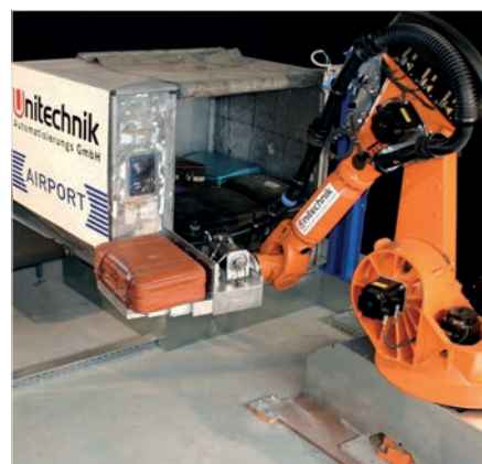
Der patentierte Greifarm mit Teleskophand nimmt das Gepäckstück vom Förderband und platziert es an optimaler Stelle im Container.
